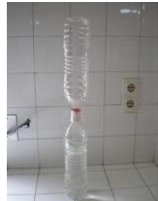
Cuando la botella con agua está sobre la botella vacía se observa que el agua no cae fácilmente a la botella inferior, pero si le damos un movimiento circular a la botella superior se genera un remolino y el agua cae fácilmente.
